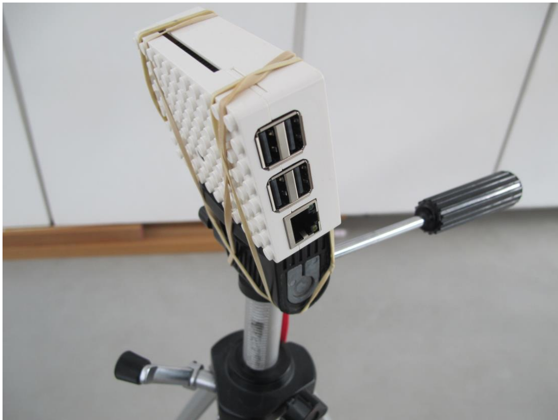
Posição da câmera (Mazi) – Tripé e computador giram ao redor do objeto
